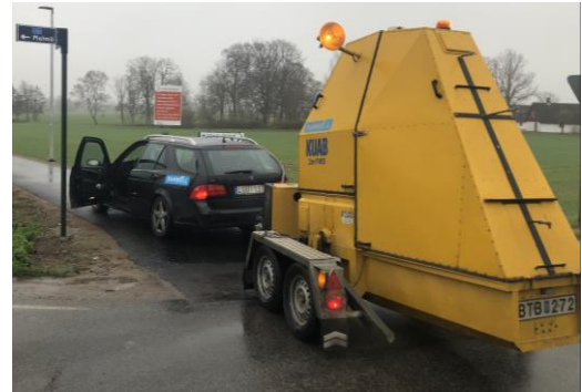
Tung fallviktsutrustning, resultatet från denna mätning grundar de bärighetsberäkningar som i studien utfördes.
