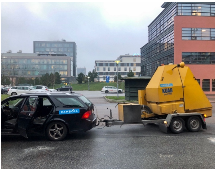
Figur 31. Ramböll RSTs fordon med tung fallvikt som använts vid mätningen.
