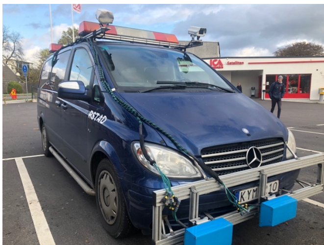
Figur 15. Ramböll RSTs fordon med tillhörande jämnhetsmätare.
