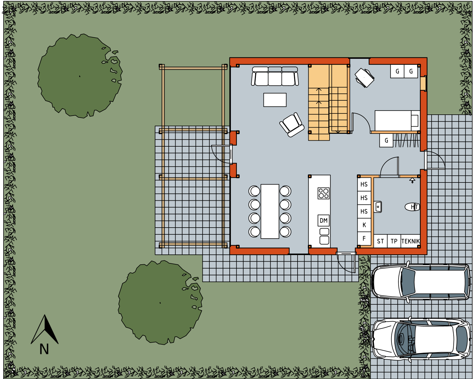
Fig 16: Plan 1 med trädgård i skala 1:100. På bottenplan är golvet av slipad betong.
