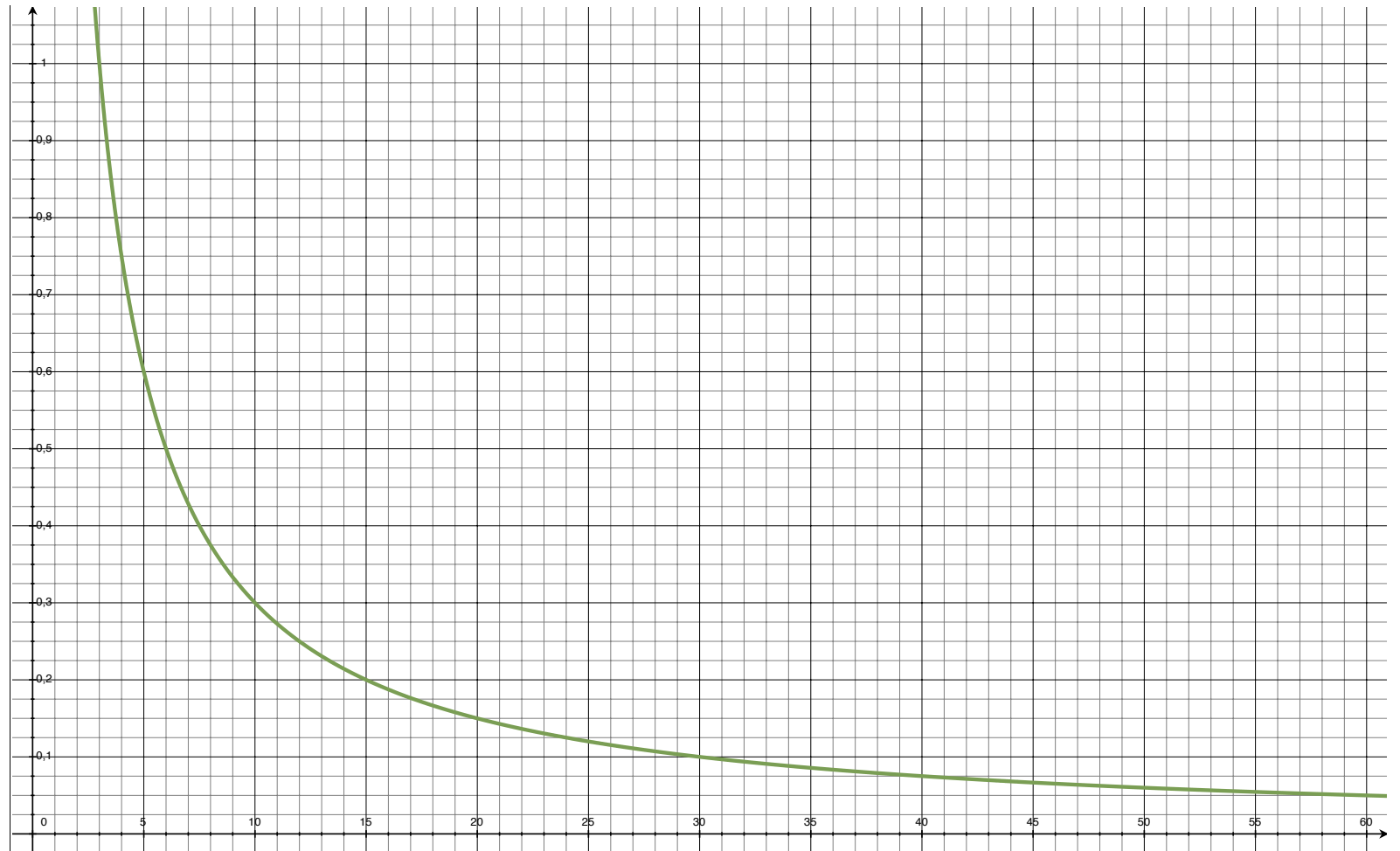
Fig 1: U-värde för en konstruktion med lambdavärdet 0,030 W/(m·K) som en funktion av konstruktionens tjocklek i cm.
