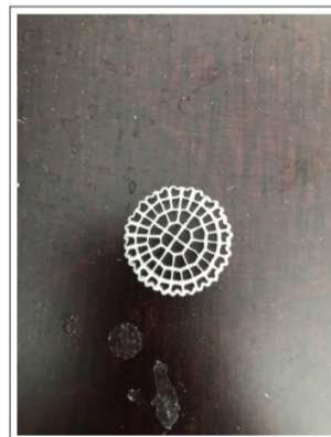
Figur 4.5 & 4.6: Siktad träflis och MBBR.bärare från AnoxKaldnes typ K5, bildkälla Sofie Sunesson
