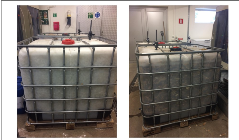
Figur 4.4: IBC 1 fylld med Anox bärare och IBC 2 med träflis, bildkälla: Sofie Sunesson
