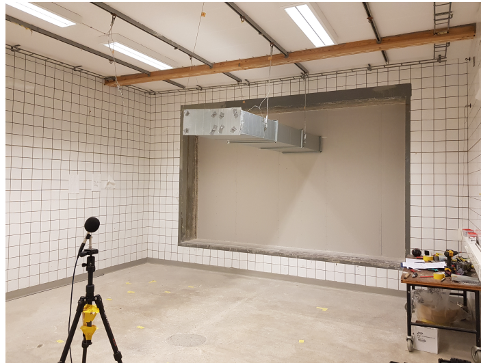
Figur 3.14: Stativ på position 1 i mottagarrummet vid sekvens AC1.
