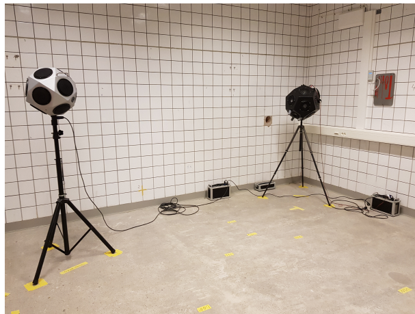
Figur 3.13: Placering av högtalarpositioner i sändarrummet.
