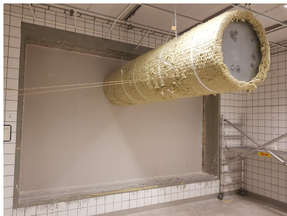
Figur 3.18: Full svepning i sändarrum enligt mätsekvens BB6.
