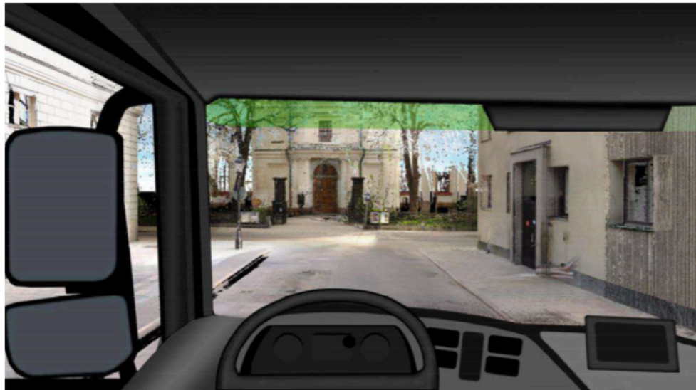
Figur 10. Aspektvinkel inifrån förarhytten (DriverView). Kameran är placerad i ögonen på föraren, 2,5 meter över marknivå.
