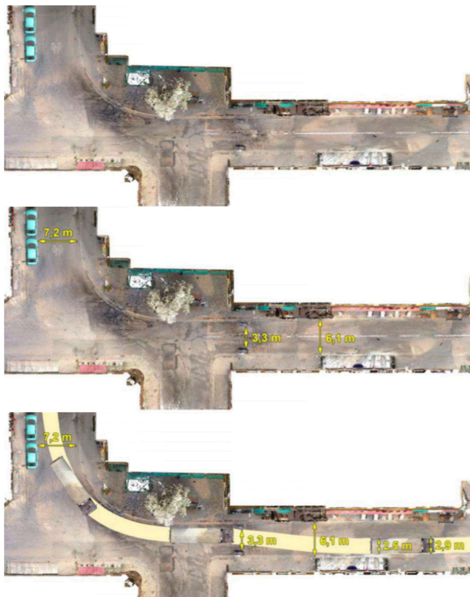
Figur 7. Längst upp visas en del av den tomma karta, i mitten inkluderad med breddmått utmed färdvägen och nederst lastbilens färdväg markerad med en gulbeige kulör. I varje zon (A till E) visas lastbilens breddmått, 2,5 m över lastutrymmet, samt 2,9 m, som är lastbilens bredd vid sidobackspeglarna.
