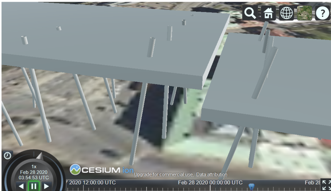
Figur 10.1: Felaktig projicering av skeppsbron i Cesium när BridgeConstructionElement konverteras till Bridge
