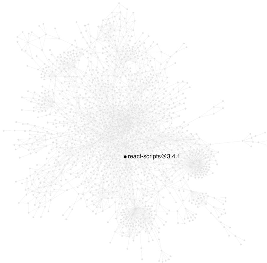
Figur 1.1: Beroendegrafen för det populära NPM-paketet react-scripts innefattar 1381 komponenter och 2927 beroendeförhållanden. Visualiseringen har skapats med hjälp av verktyget “Visualization of NPM dependencies” som är tillgängligt via https://NPM.anvaka.com/
