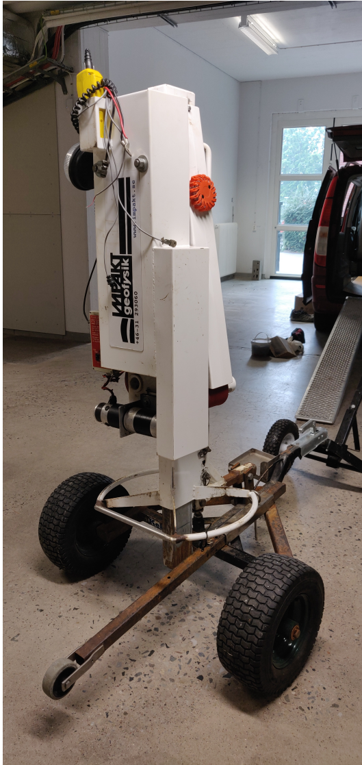
Figur 31: Elastisk driven seismisk stötkälla i form av en Gisco ESS 100 Turbo. Vikten accelereras av elastiska element av någon elastomer, ”gummiband” (se högra bilden). Foto: Kristian Eng
