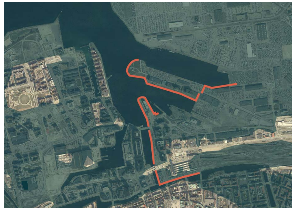
Water level at +3,0m (RH2000) Information from Myndigheten för samhällskydd och beredskap, översvämningssportalen Barrier is needed. Where a barrier is not needed the municipality will work with landfill. FÖP Nyhamnen 2019 Ortofoto Malmö (u.å) Malmö Stadsbyggnadskontor
