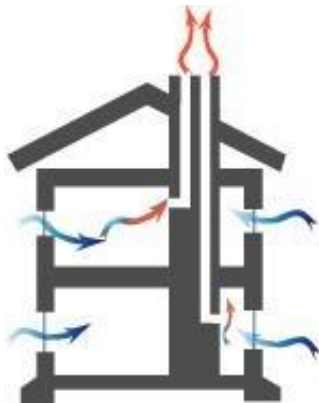
Figur 13: Självdragssystem, principskiss (Svensk ventilation, u.d.)
