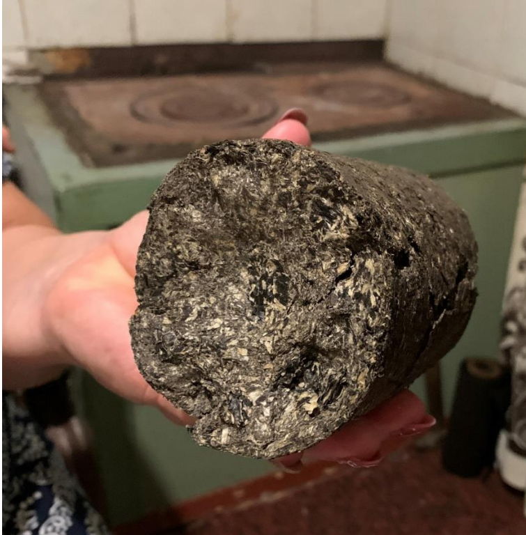
Figur 3.49: Bild på solrosbrikett som används till uppvärmning. Husets primära uppvärmning, kaminen framgår i bakgrunden.
