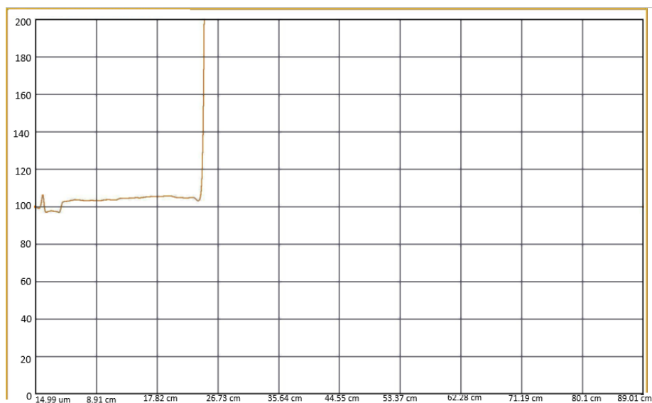
Figur 25: Kalibrering av mätutrustning inför TDR-mätningar, med öppen ändpunkt. Y-led visar karakteristisk impedans i ohm [ \Omega ]. X-led visar placering i den länk som mätningen görs på, med startpunkt i instrumentets kabelkontakt, i enhet meter [m].
