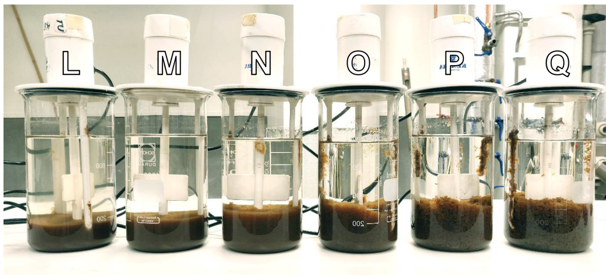
Figur 20. Försök 4 – återflockning av industriavloppsslam. Från vänster till höger: Endast omrörning (bägare L), ökande polymerdos (bägare M-Q).
