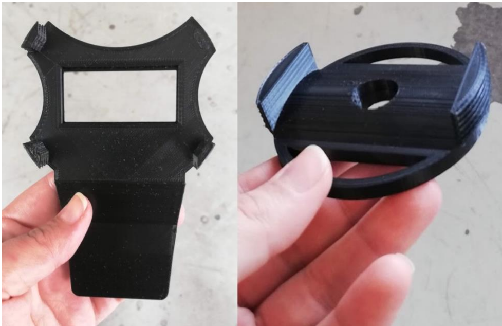
Figur 6.3: 4-delad till 2-delad gänga
