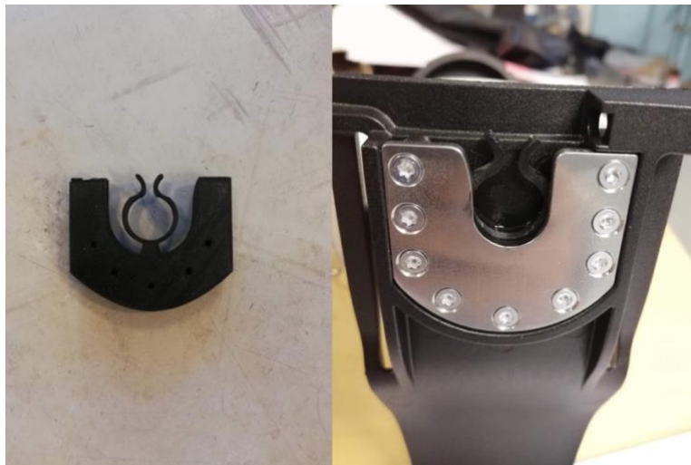
Figur 5.10: Compliant mechanism av nuvarande bältesclip
