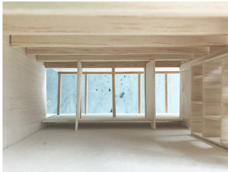
Bilder från modellen i 1:50 av F-3:ans hemvist som visar de olika takhöjderna.
