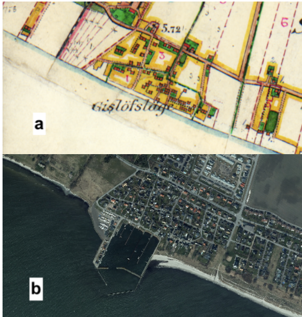
Fig. 6. (a) Häradsekonomska kartan från 1910-15, visandes en rak kustlinje vid Gislövs läge (f.d. Gislöfsläge). (b) Ortofoto från 2018, samma plats som (a). En hamn har konstruerats sedan (a) ritades och kustlinjen öster om hamnen har förskjutits mot havet medan en reträtt av kusten skett öster om hamnen.
