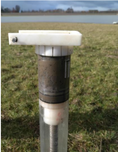
Figur 4 HTH tub på strängspruta som pressar ut borkärna till snittbricka.
