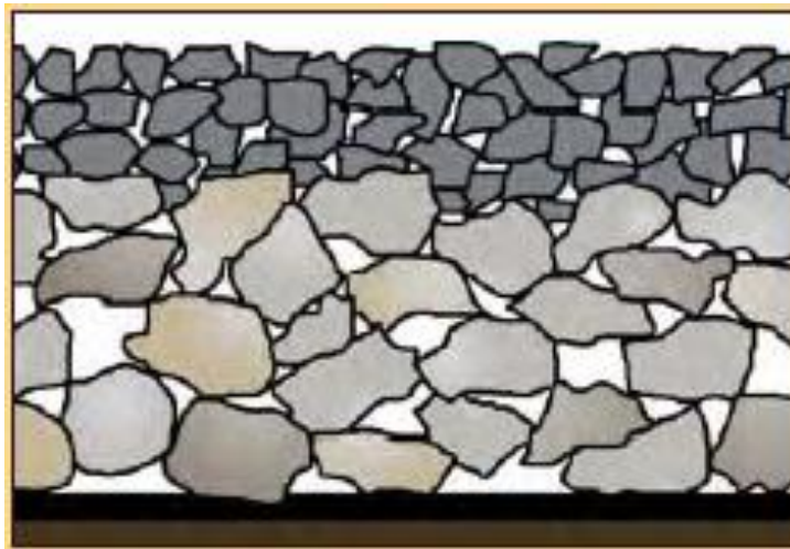
Figur 3.6 - En tvålagers ABD-beläggning. En så kallad dubbeldrän. Notera det övre, tunnare lagrets, mindre stenstorlek.
