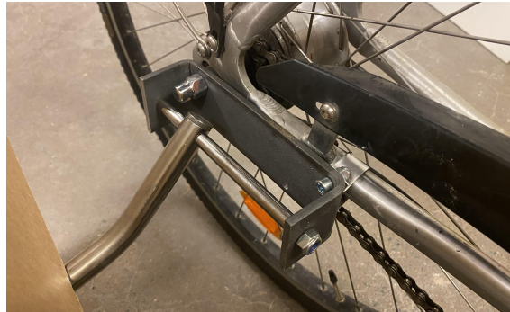
Figur 7.18 Fäste och vagnskoppling i Prototyp 1.
