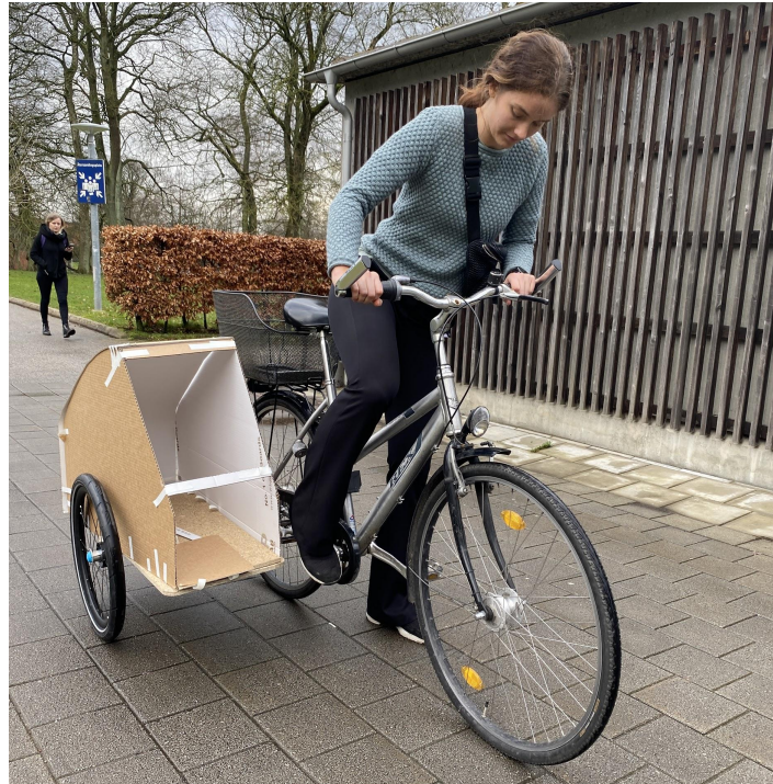
Figur 7.14 Första prototypen av sidovagnen
