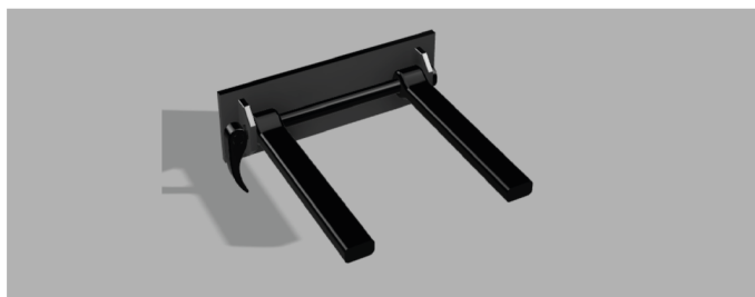
Figur 7.31 Illustrerar CAD-modell med sprint
