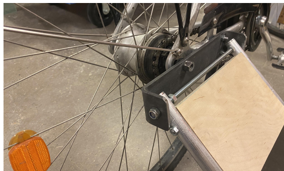
Figur 7.20 Fäste och vagnskoppling i Prototyp 3.
