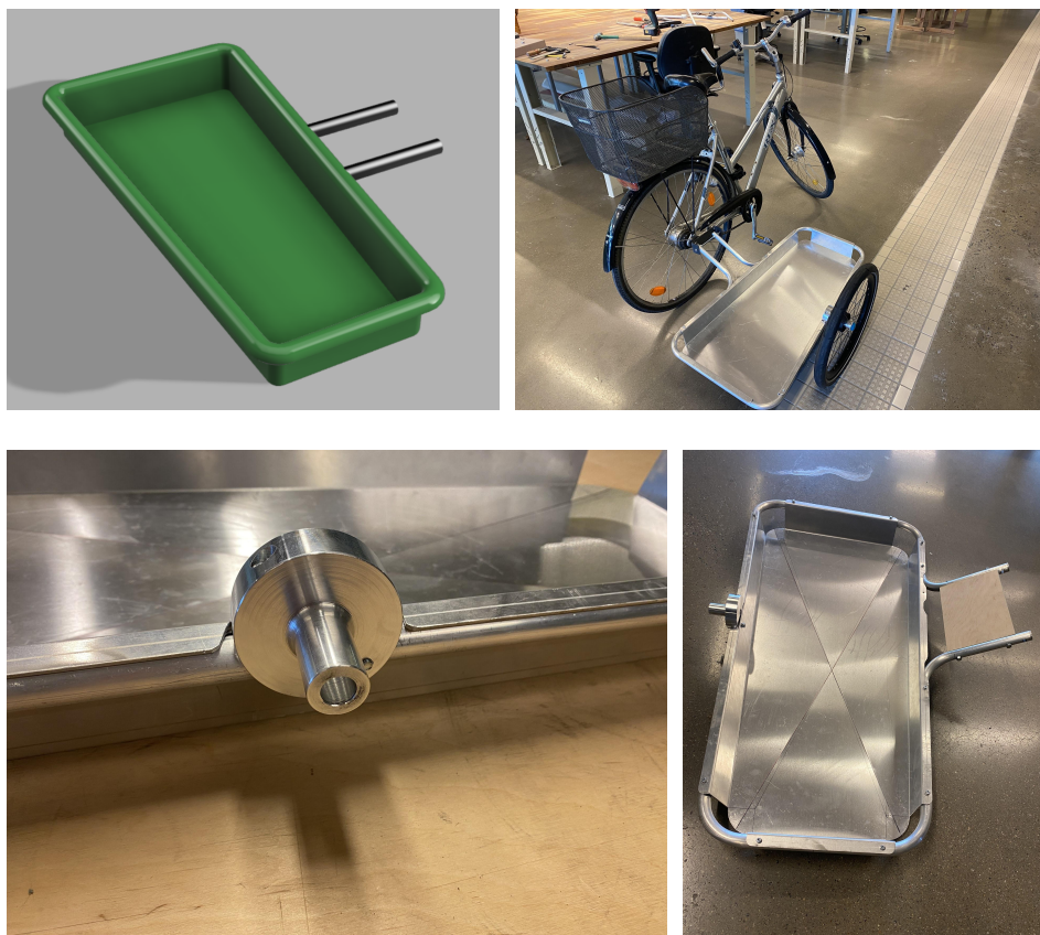
Figur 7.37 CAD-modell av koncept uppe t.v., Prototyp 2 uppe t.h., hjulaxeln nere t.v. och Prototyp 3 nere t.h.
