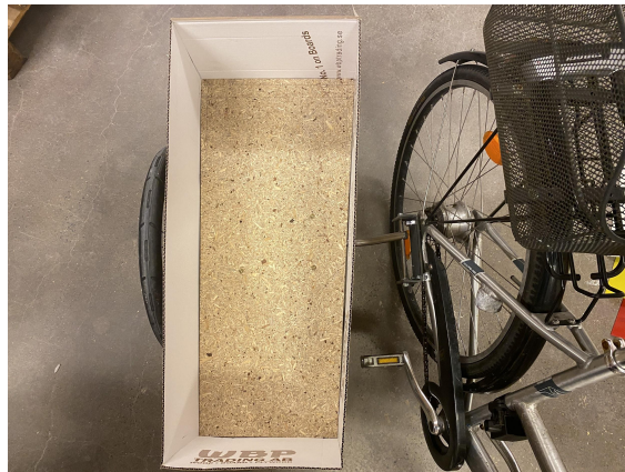
Figur 7.34 Bottenplatta 2 testas vid cykling.
