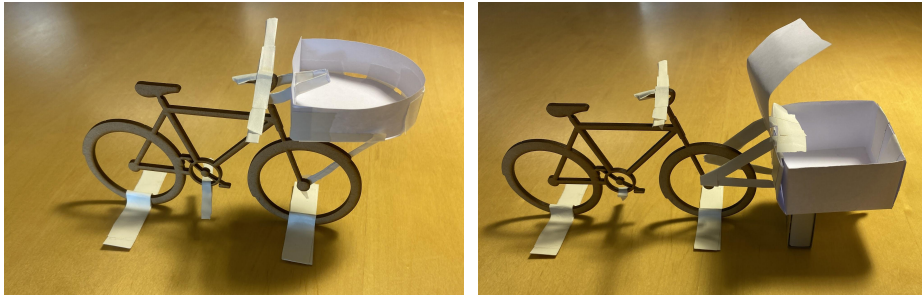
Figur 7.10 Test av vagn framtill på cykeln.
