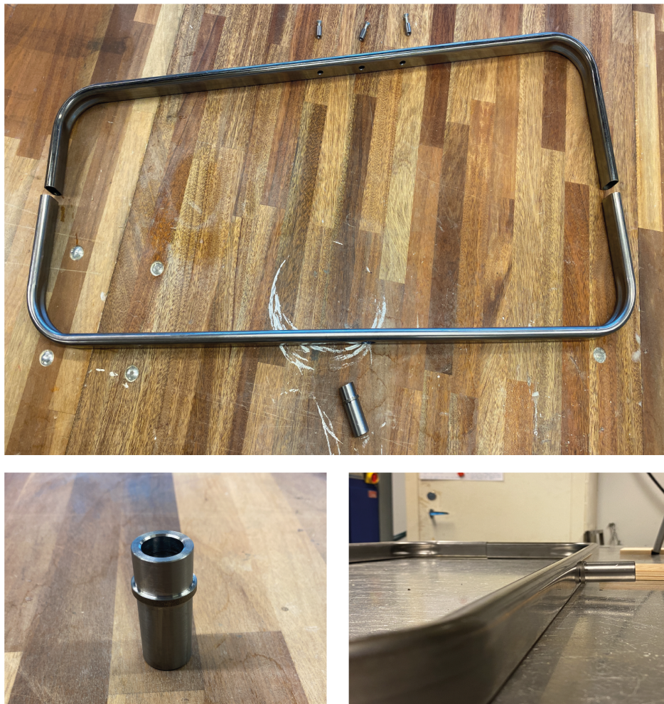
Figur 8.5 Hjulaxel som svetsas fast i rörverket.
