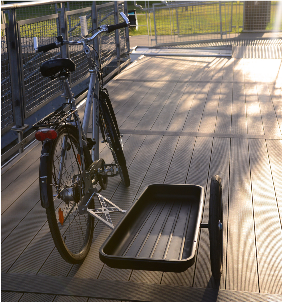
Figur 9.8 Verklig prototyp av fraktvagn.
