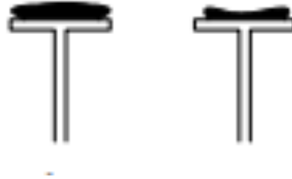
Figur 3.7: Illustration av felaktigt trimmade provkroppar (Baklökk m.fl. 2002).
