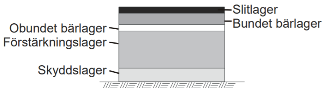
Figur 2.1: Principiell uppbyggnad av en vägöverbyggnad (Trafikverket, 2011).
