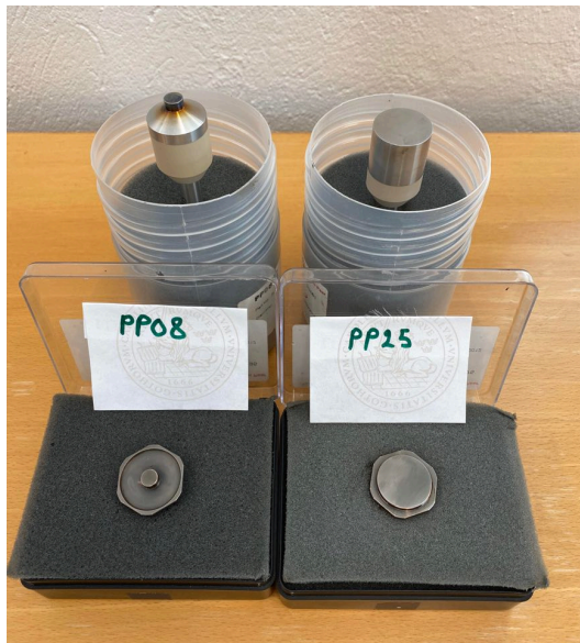
Figur 3.2: Spindel och mätplatta till PP08 och PP25.
