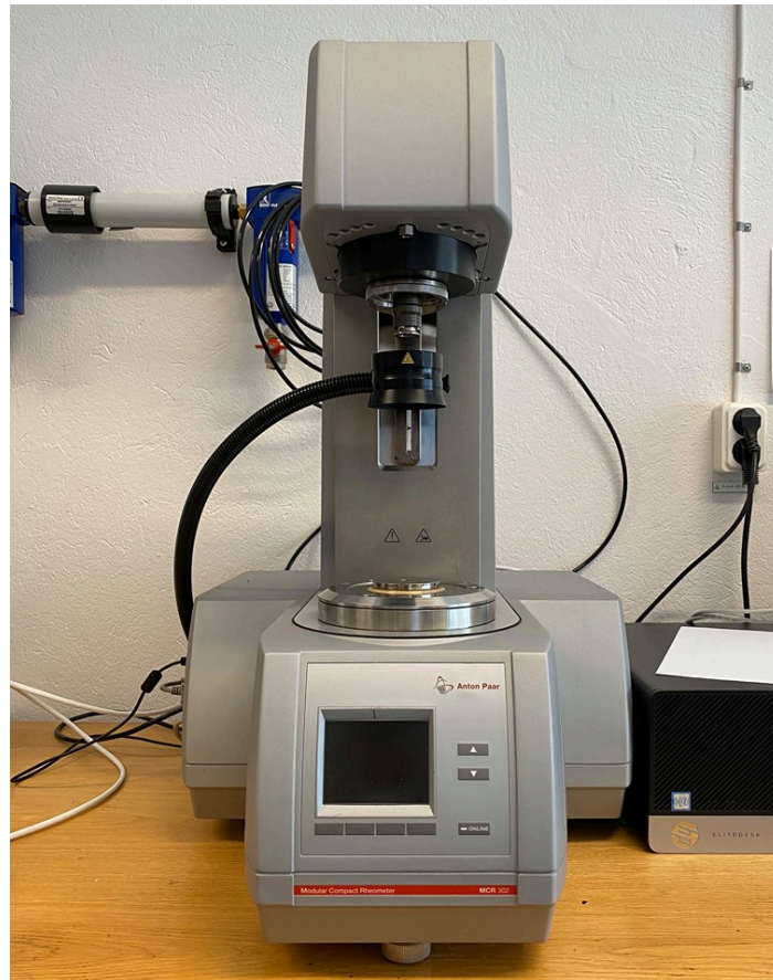
Figur 3.1: Dynamisk skjuvreometer (MCR 302) av Anton Paar i Reologilaboratoriet på Lunds Tekniska Högskola.
