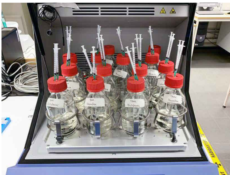
Figur 11: Den experimentella uppställningen vid försök 2. På bilden syns bägarna med tillsatt biologi, gasfälla och kanylerna som användes vid provtagning. Bägarna står på ett skakbord.
