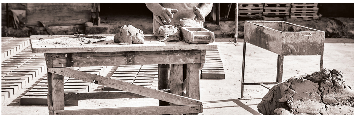
Fig. 20. Strykning av tegel i träform. Råteget torkas på marken, innan det kan hanteras så pass att det kan staplas för genomtorkning.
