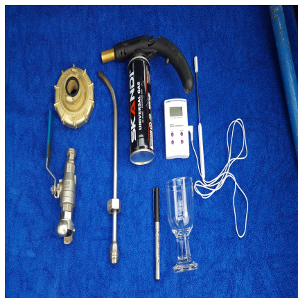
(b) Till vänster i bild visas delar som fästs på brandpost. Brännare, termometer, vattenfast penna och glas.
