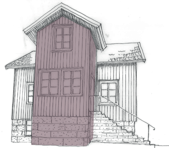
Trapphus placerade på utsidan korsplanen underlättade vertikal rörelse utan inträng. Källarplanet kunde dessutom nås via en direkt ingång.
