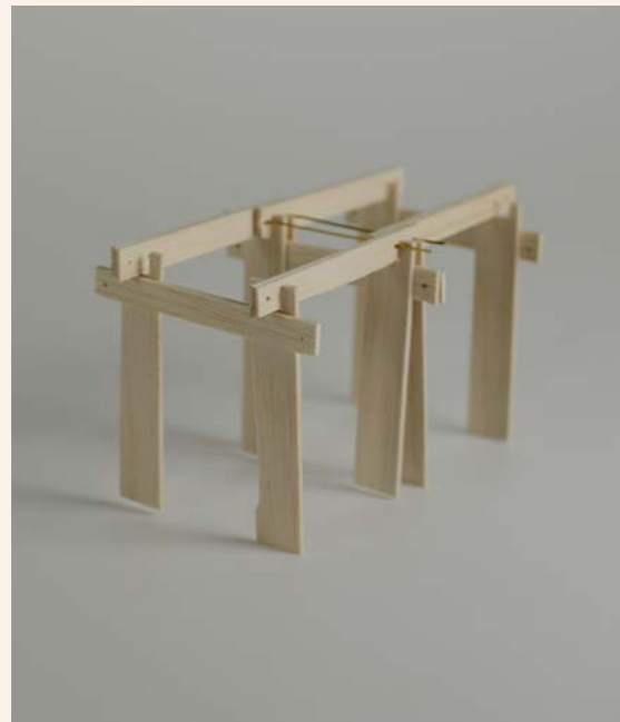
Studie av re-monterbara konstruktioner och fogar
