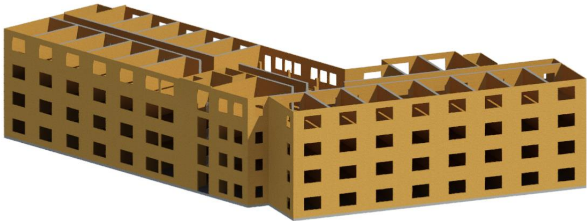
Figur 15 Bärande element i trästomme (transparent takbjälklag)
