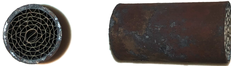
Figur 3. Vattenbehandlad monolit som användes som bärare sedd ovanifrån (vänster) och från sidan (höger)
