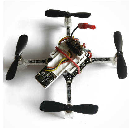
Figur 1: Mini-drönaren Crazyflie från Bitcraze AB, här med en kamera och en videosändare monterade. Drönaren mäter 9,2 cm från motor till motor.
