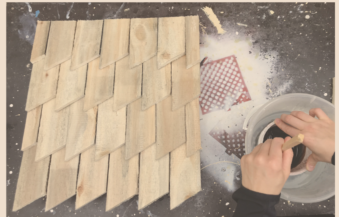
Fasadmodell av aspspån från Glommersträsk redo att tjäras.
