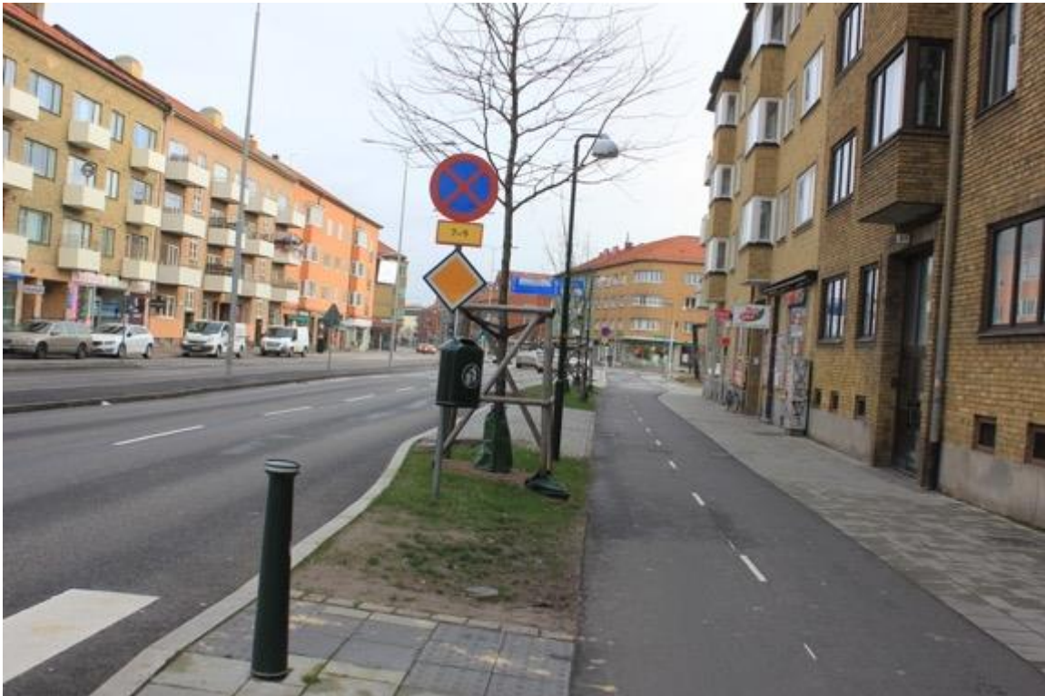
Figur 23 - Bilden visar ett träd som placerats i nära anslutning till belysningsanordningen, vilket kan ha en negativ inverkan på belysningen när trädet växer sig större
