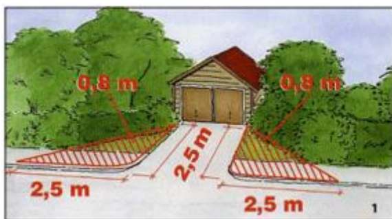
Figur 15 - Vid utfarter ska siktrianglar hållas fria från vegetation för att förhindra trafikolyckor (Malmö stad, 2006).
