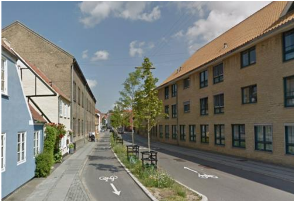
Figur 4 - Plantering mellan cyklister och motorfordon kan separera cyklister som cyklar i motsatt riktning mot motorfordon på en enkelriktad gata, Aarhus (källa: Google maps, 2019)
