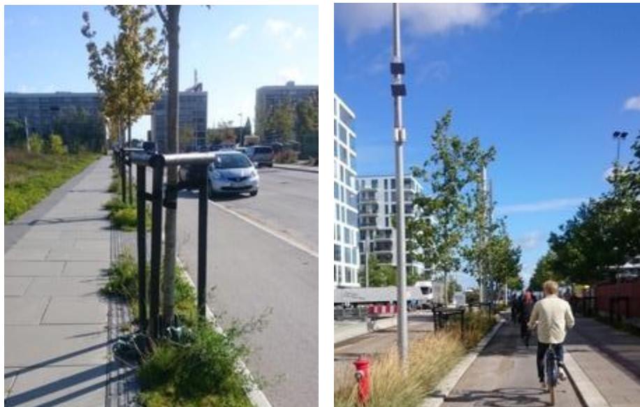
Figur 2 - Exempel från Aarhus, vegetationens placering i gaturummet, till vänster mellan cykelbana och trottoar, och till höger mellan cykelbana och körbana (2019).
