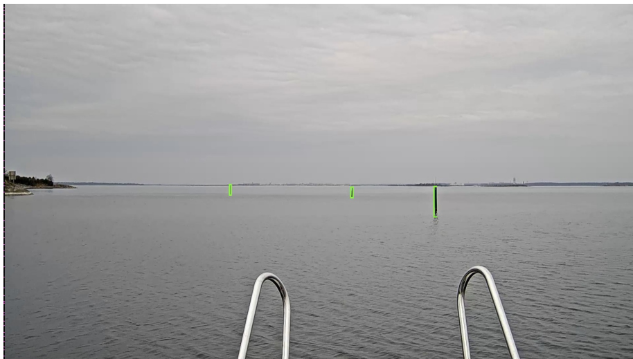
Figure 2: Bild som visar resultatet från vår algoritm när den applicerats på Figur 1. De hinder som hittats har markerats med en grön rektangel.
