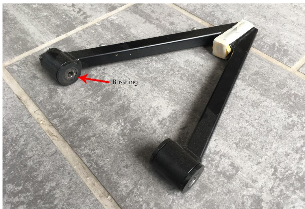
Figur 3.2 Tidig övre bärarm med monterade bussningar.
