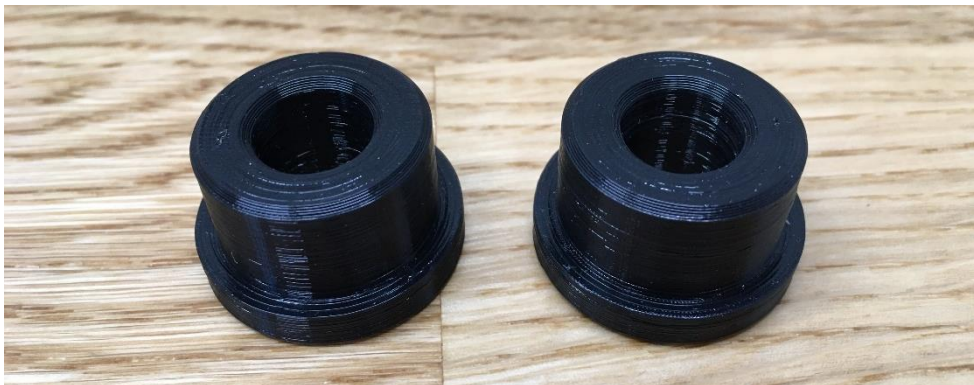
Figur 5.6 Referensbussningar utan defekter eller utsatta för några miljöfaktorer.
