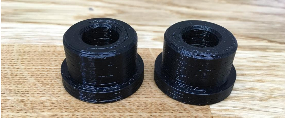
Figur 5.5 Bussningar med fukt i filamentet.
