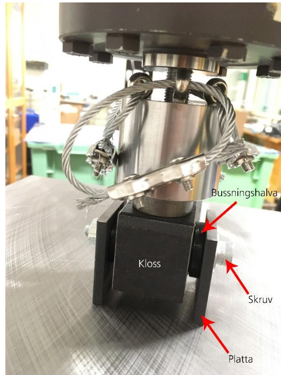
Figur 5.4 Jigg för bussningar i pressmaskin.
