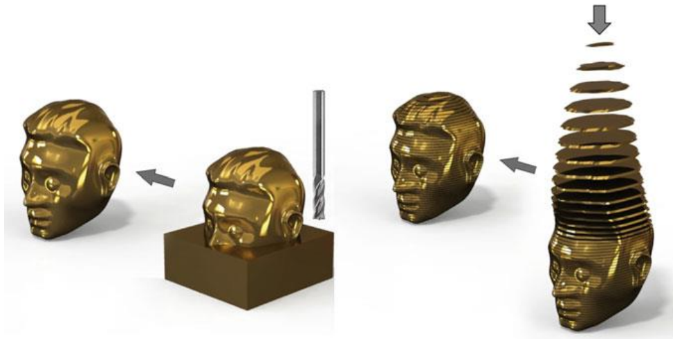
Figur 3.9 Subtraktiv respektive additiv tillverkning. [9]
