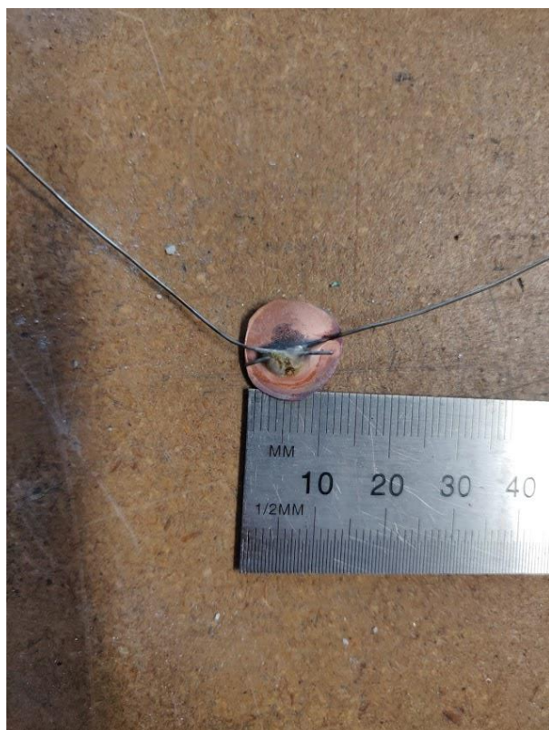
Figur 44 Koppardisken med ett termoelement som är lodat.
