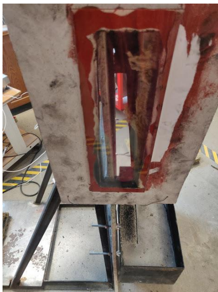
Figur 15 Ena sidan av fasaden är ogenomskinlig. Det går att se de termoelement som är placerade i luftspalten.
