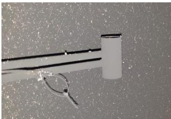
Figur 21 Utseende av ett horisontellt placerat bi directional probe . Bilden är tagen framifrån. Ett termoelement är placerat till vänster om bi directional proben .
