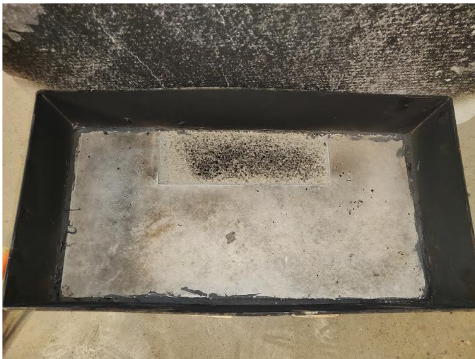
Figur 16 Sandboxburnern sett ovanifrån. En yta på 10 x 30 centimeter kapades ut från en obrännbar skiva där gasolen tilläts passera vilket ses i ovankant av brännaren. Bilden är tagen uppifrån.
