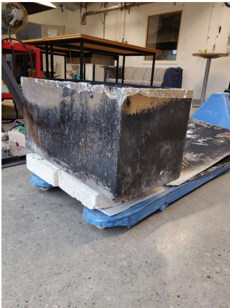
Figur 17 Upphöjningen av sandboxburnern skedde med hjälp av en truck och staplade lättbetongbitar.
