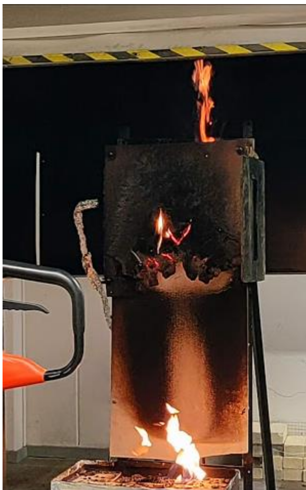
Figur 39 Bilden är tagen framifrån vid tidpunkten då gasolen stängs av och PIR-skummet brinner. Lågor syns i mitten av fasaden där HPL-panelen lämnat ett hål samt i toppen av luftspalten. Gasolbrännaren syns längst ner och står på trucken.
