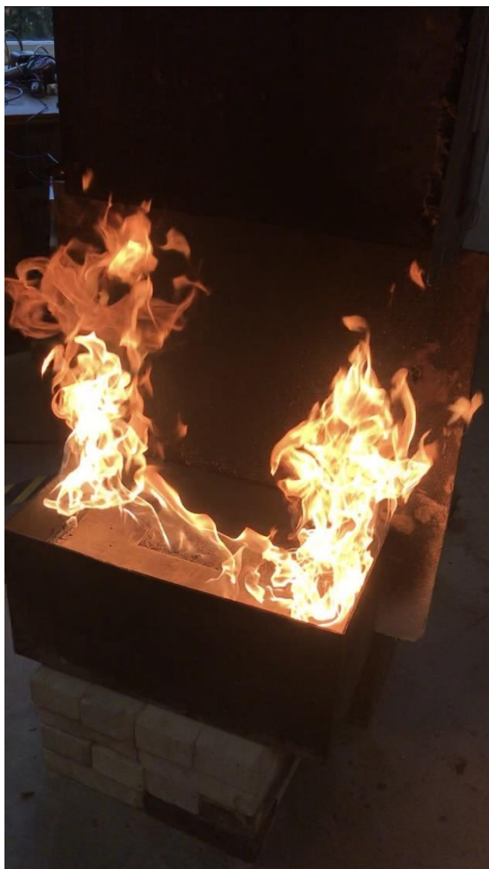
Figur 19 U-formad flamma som uppstod vid höga effekter.
