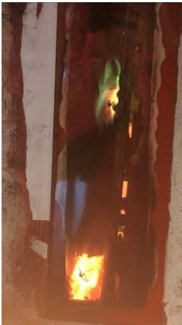
Figur 32 Bild på grön flamma som orsakas av att brandstoppet brinner. Brandstoppet har svällt och syns som en svart yta. Det går att se lågor under brandstoppet samt ett termoelement. Bilden är tagen igenom glasrutan som placerades till höger i testuppställningen.
