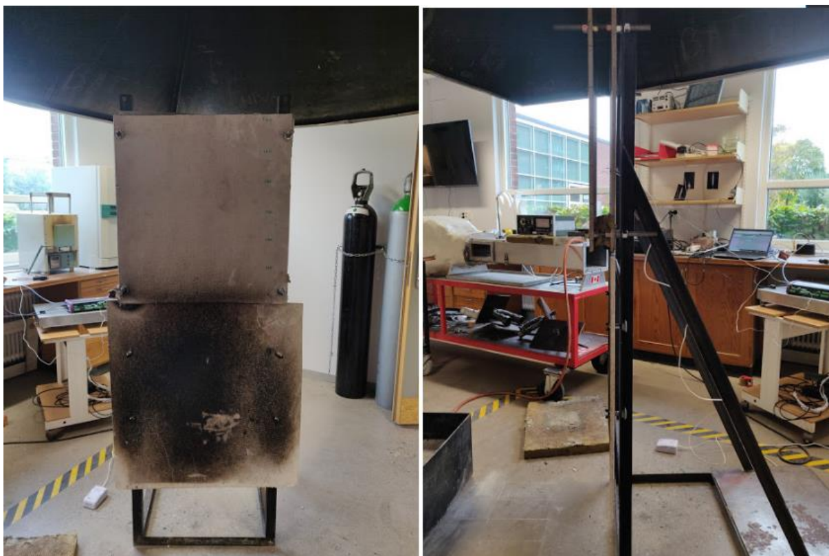
Figur 14 Bilden till vänster är fasaden sett framifrån utan brännaren. Bilden till höger är fasaden sett från sidan och det går att se spaltbredden. Den undre skivan syftar till att skydda ställningen mot värmepåverkan. De två övre skivorna bildar luftspalten, där placerades mätinstrumenten.
