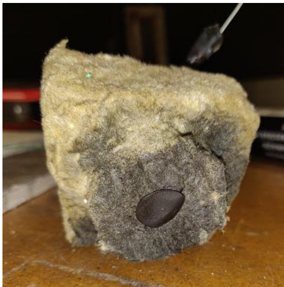
Figur 20 TSC-mätare. Svart cirkulär platta är koppardisken som målats med värmebeständig svart färg. Isoleringsmaterialet kan ses och termoelementen sticker ut på baksidan.
