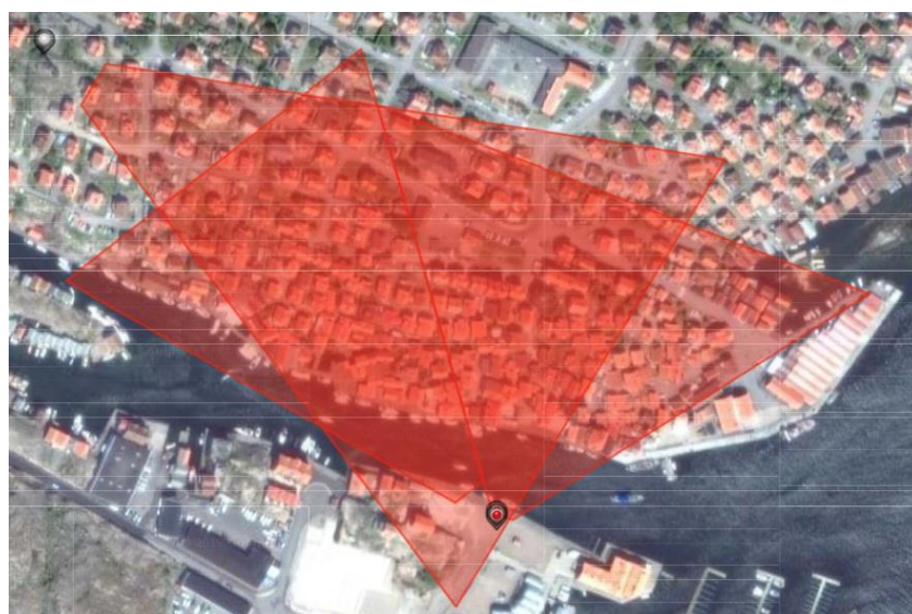
Figur 4 – Värmekamerorna täckningsyta på Smögen. Foto med tillstånd: Peter Bergman
