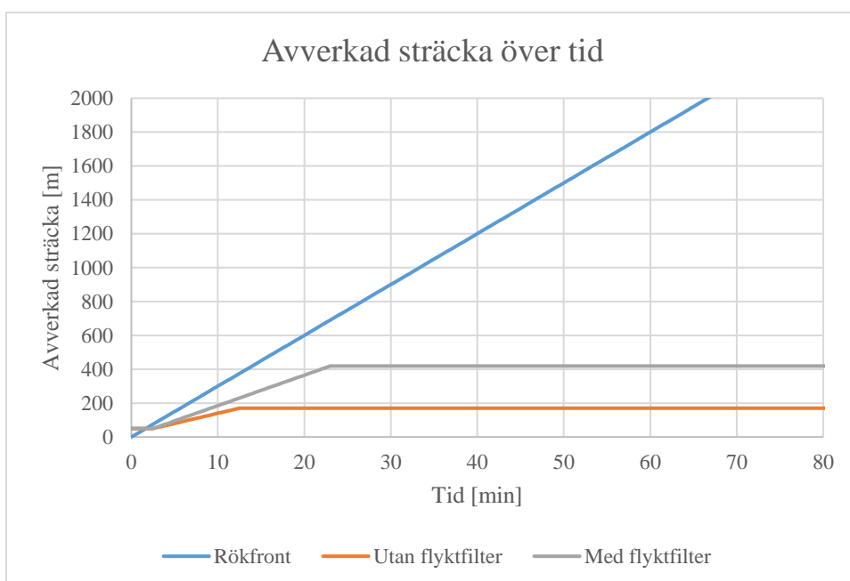
Figur 13. Avverkad sträcka för rökfront, utrymmande person utan flyktfilter och utrymmande person med flyktfilter för scenario A – borrigg med tunneltvärsnitt 5x5 m 2
