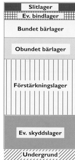
Figur 2 - Principiellt utseende av dagens vägkonstruktion. Källa: asfaltboken.se
