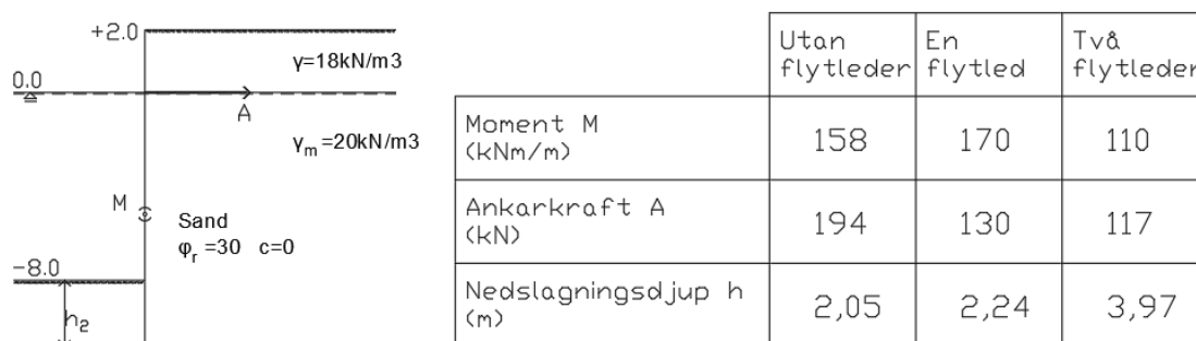
Figur 3.12: Brott utan, med en respektive med två flytleder samt resultat, tagit inspiration från [6].
