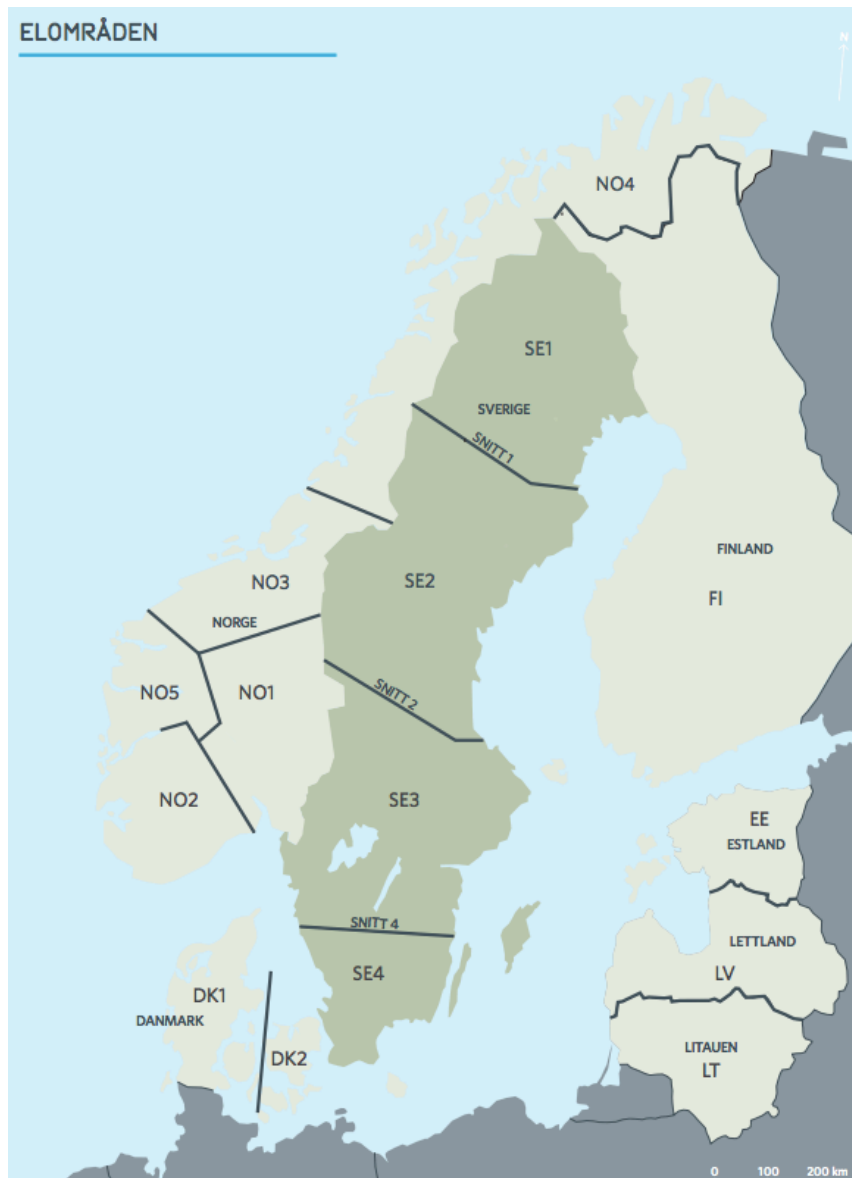
Figur 3: Sveriges fyra elområden samt de tre snitt där flaskhalsar frekvent uppstår till följd av kapacitetsbrist (Svenska kraftnät 2019)
