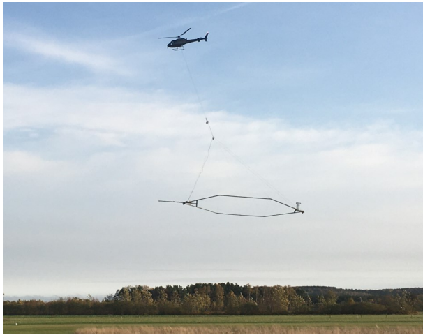
Fig. 6. Helikopterburen spole under SkyTEM-mätning. Foto: Peter Dahlqvist.
