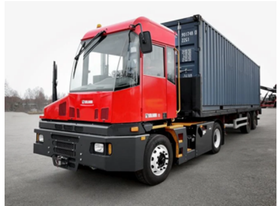
Figure 4.7 Terminal Tractor (Kalmar (3), 2021)
