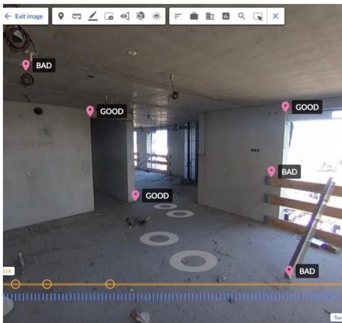
Figur 11 visar exempel på var man bör placera kontrollpunkter i 3D-modellen (Reconstruct 2020a)
