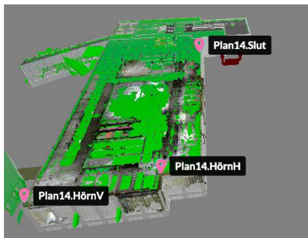
Figur 13 Alignment workflows resulterar i sammankoppling av BIM-modell och 3D-modell.
