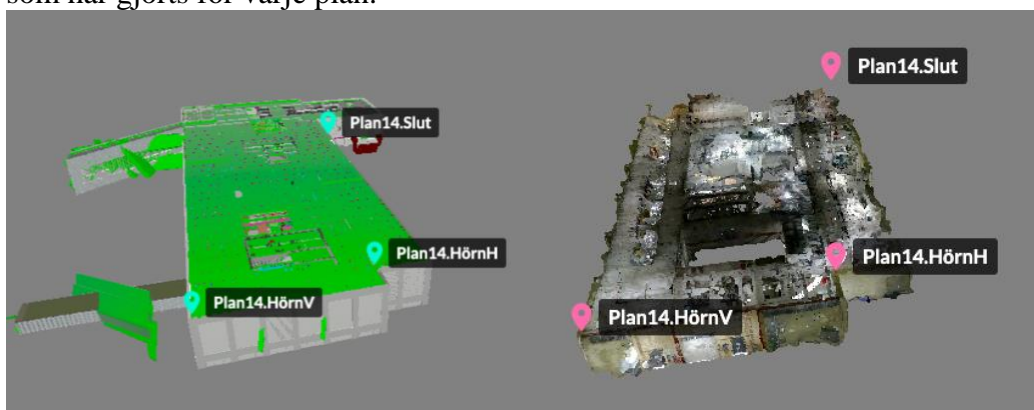
Figur 12 I första hand är BIM-modellen inte integrerat med 3D-modeller men genom att ange kontrollpunkter i både modellerna sker en sammankoppling.
