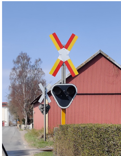
Figur 2.6: Vägmärke A39 och signalbild Y1 vid järnvägs korsning. Fotografi taget på Gälltoftavägen i Rinkaby.
