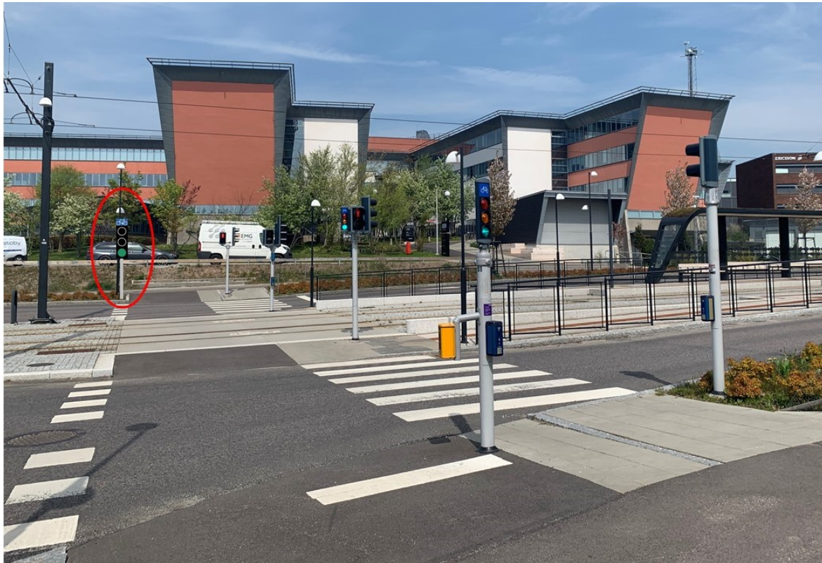
Figur 4.1: Förslag från Johan Wahlstedt om en extra sekundär cykelsignal vid den signalreglerade övergången vid Telefonplan (illustration av trafikljus från Transportstyrelsen (2019)).
