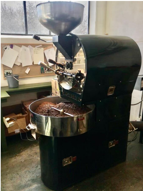
Figur 2. Soldes gasdrivna trumrost. På bilden ses bönor under avkylningssteget där kall luft blåses för att kyla ned bönorna.
