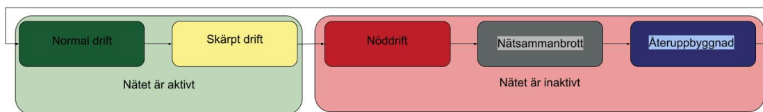
Figur 2.1: Elsystemets drifttillstånd, och hur de hänger ihop, visualiserat.
