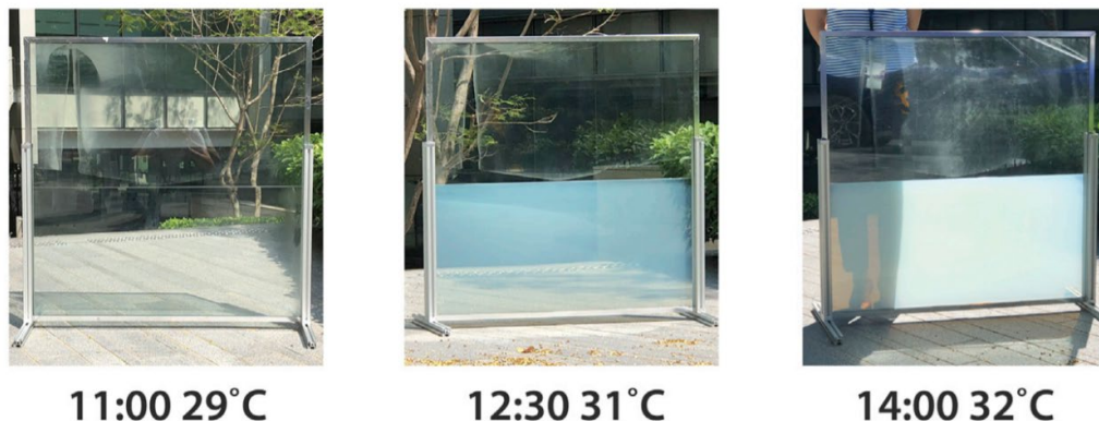
Figur 2.9. Här visas hur vatten- och hydrogelsfönstret ser ut vid olika temperaturer. Fönstret blir ogenomskinligt vid högre temperaturer vilket leder till lägre temperaturer inomhus vid varma somrardagar (Zhou, et al., 2020).
