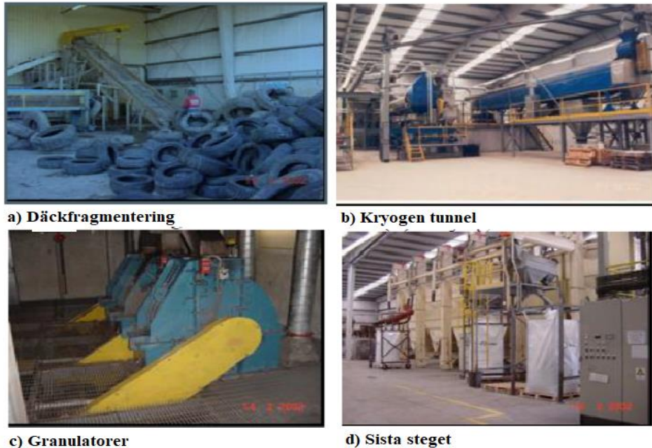
Figur 9: Lågtemperaturprocessen med dess olika steg (Silvrano m.fl. 2006). Figurerna används med tillåtelse av skaparna.
