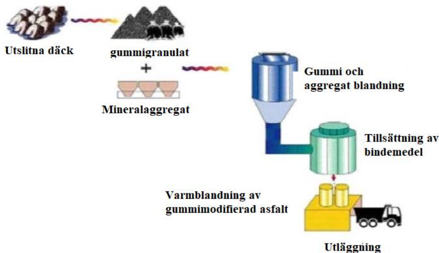
Figur 11: Tillverkning av gummimodifierad asfalt med den torra metoden. Figuren används med tillåtelse av skaparna (Silvrano m.fl. 2006).
