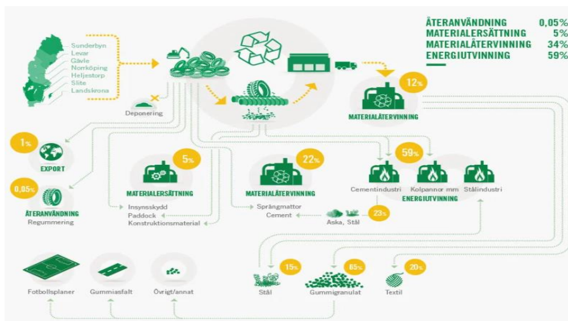
Figur 7: Återvinningsprocess av fordonsdäck i hela Sverige. Figuren används med tillåtelse av skaparna (Ragn - Sells Däckåtervinning AB, 2019).
