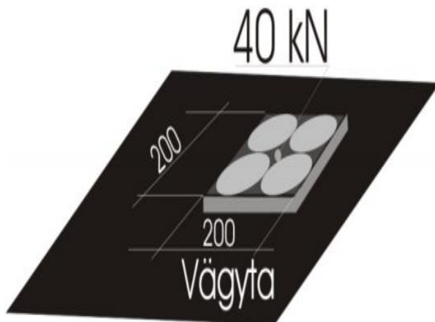
Figur 3: Enstaka last för överbyggnad till GC-väg, med en axellast mindre än eller lika med 8 ton (Trafikverket, 2011).
