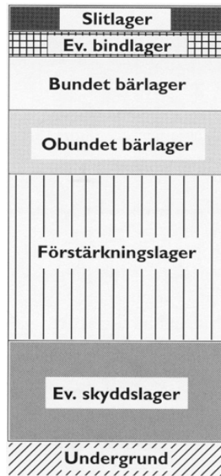
Figur 2–1. Principiell lagerföljd av dagens vägkonstruktion (Asfaltboken, 1999)
