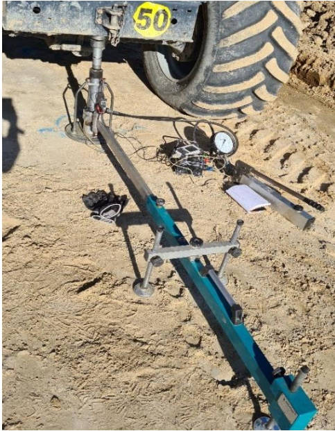
Figur 5. Utrustning för statisk plattbelastning. Källa: Egen bild
