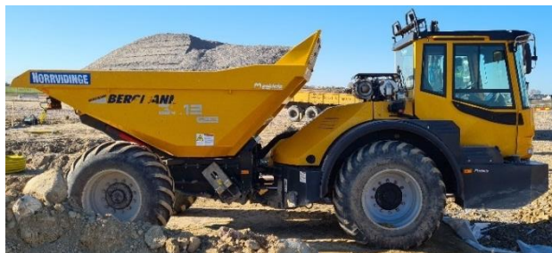
Figur 27. Motvikten som användes vid mätningarna vid utläggning. Källa: Egen bild
