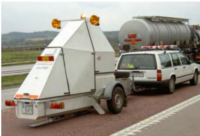
Figur 8. Fallviktsmätning med fordon. Källa: (Trafikverket, 2012)
