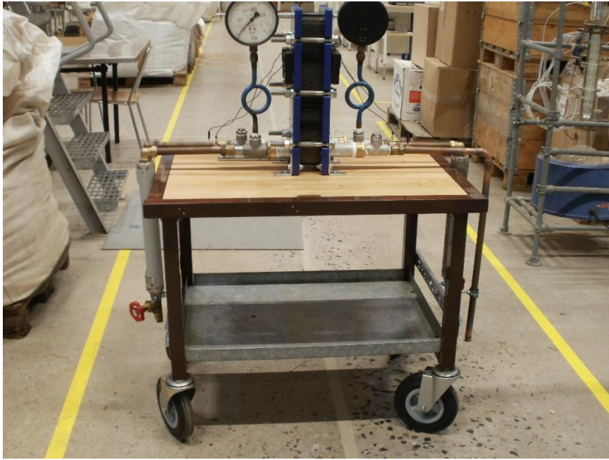
Figur 3. Laborationsstation med en 2-pass H-kanal värmeväxlare kopplad i motström på en bordvagn.
