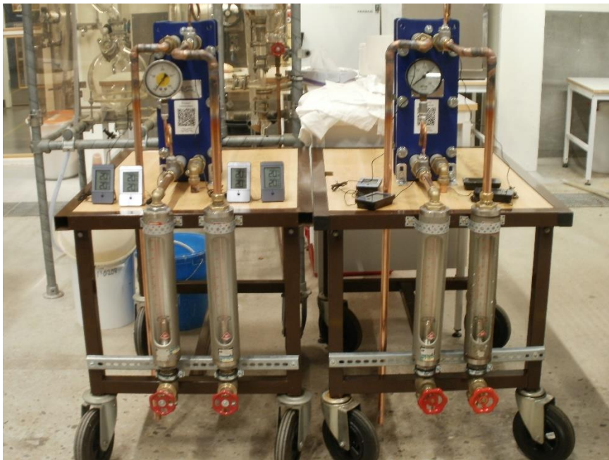
Figur 4. Laborationsstationer, en med 1-pass H-kanal och en med 1-pass L-kanal värmeväxlare kopplad i motström på vars bordvagn.
